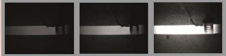
真实 VIS ( 可见光 ) THERMALVISION™ 摄像机测量杆 温度 750°F [400°C] ~ 2865°F [1575°C]
