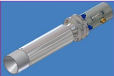
EXTREME TEMP 高温用カメラは、ULTRA TEMP 高温用カメラにインコネル製の耐熱ジャケットを装着し、より高温の環境に対応させたタイプです。炉内をモニタする為に炉壁レンガの開口部から挿入します。
