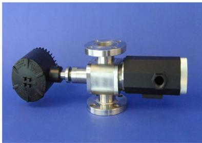
インフローは、水中の油と砂、および油中の水と砂の PPM/PPB、粒度分布を測定します。165m/min の流速で 5%濃度（砂/泡）の場合で±1%の精度です。測定可能な粒子サイズは 0.7 μm 以上です。データは Excel またはデータベースに保存されます。画像、またはビデオの保存もできます。インラインでもラボでも使用できます。
