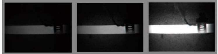
可視光 VIS による焼けた金属棒の温度測定 (400～1575℃)
