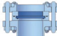
クウォーツシールド又はサファイヤシールドタイプは、耐腐食性を要求される場合に使用します。
