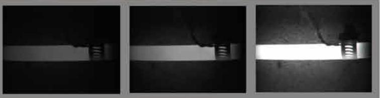
Aktuelle VIS THERMALVISION™ Kamera-Messung von Temperaturen von 400°C bis zu 1575°C
