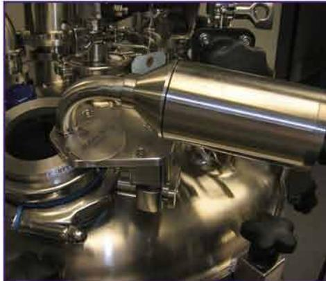
CANTY HYL 52 und HYL 82-Steril- Leuchten sind nach hygienischen Anforderungen konstruierte Leuchten für die Biotech-Industrie. Durch eine hohe Leuchtkraft und reines weißes kaltes Licht, werden die Behälter optimal ausgeleuchtet ohne den Prozess selbst zu erhitzen.
